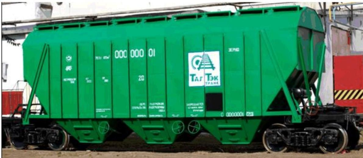
Вагон-хоппер модели 19-9950- четырехосный цельнометаллический крытый вагон с четырьмя загрузочными и шестью разгрузочными люками.
